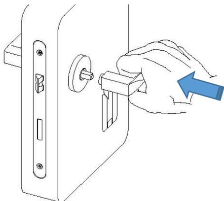
Установите внутреннюю ручку Velox на розетку. Вставьте внешнюю ручку так, чтобы квадратный стержень вошёл во внутреннюю ручку, прижимая их друг к другу по оси. Функция фиксации квадрата VELOX fix сработает автоматически.
