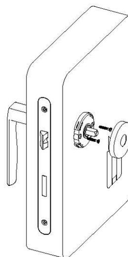
Закрепите базу розетки с помощью саморезов и установите на неё декоративную крышку, просто надавив на неё.
