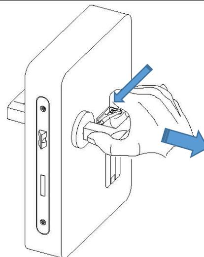
Для демонтажа ручки вставьте съёмник Velox fix в отверстие внутренней ручки. Вытяните ручку с квадрата. Обратите внимание: не используйте любой другой ключ для разборки, он может повредить систему Velox fix.
